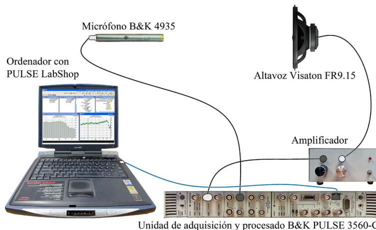
Figura 6: Diagrama de conexiones de los equipos utilizados en la medición del prototipo experimental.
