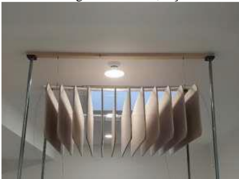
Figura 8 - Colocação de 12 baffles para ensaio
