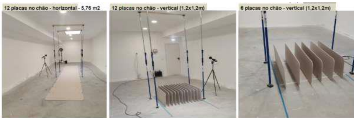
Figura 11 - Colocação do provete na horizontal, na vertical 12 elementos e 6 elementos
