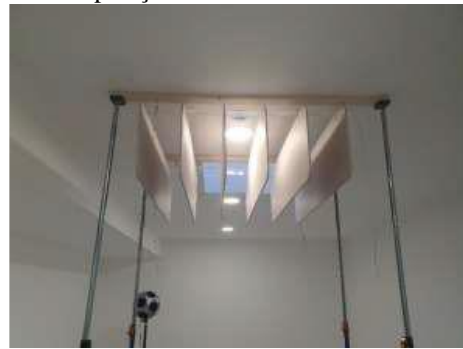
Figura 9 - Colocação de 6 baffles para ensaio
