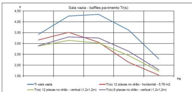
Figura 12 - Colocação do provete na horizontal, na vertical 12 elementos e 6 elementos
