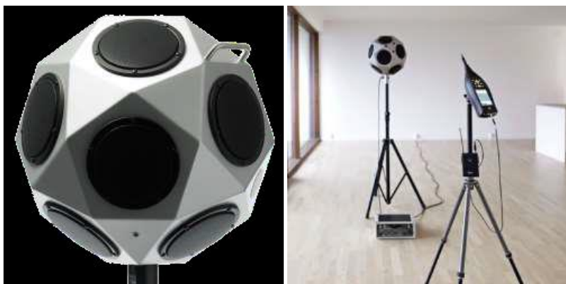
Figura 5 - Fonte Dodecaédrica omnidirecional Tipo 4292 da Brüel & Kjaer e Conjunto de medição acústica composto por Fonte Omnidirecional, amplificador, transmissor e sonómetro.
