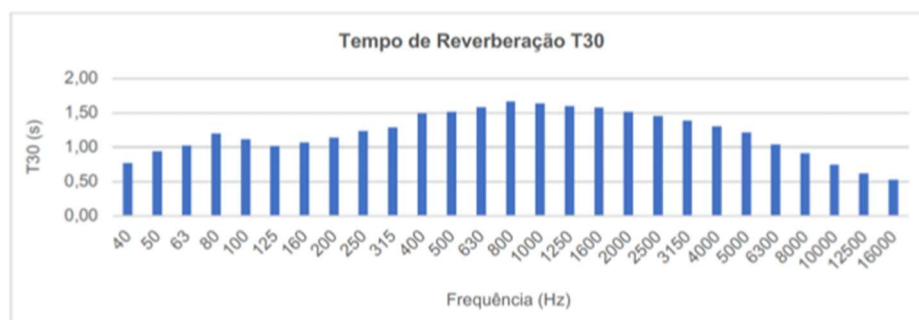
Figura 6 – Gráfico das medições do tempo de reverberação em 1/3 de oitava T30.
