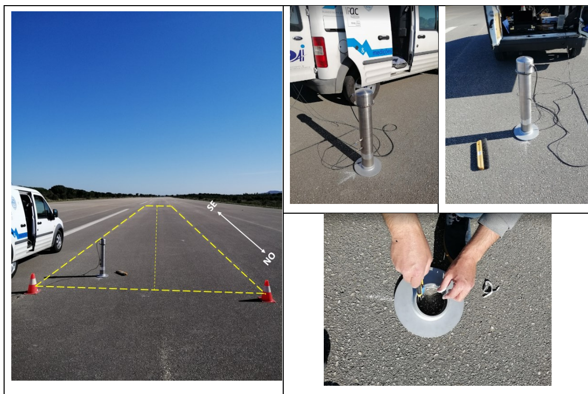
Figura 10 – Perspetiva da área de medição e colocação do tubo de medição sobre a pista. Fotos dos autores
