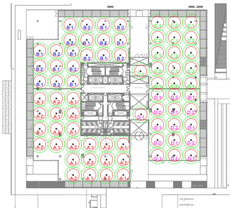
Figura 6 – Distribución de líneas de altavoces según la norma UNE 60849.
