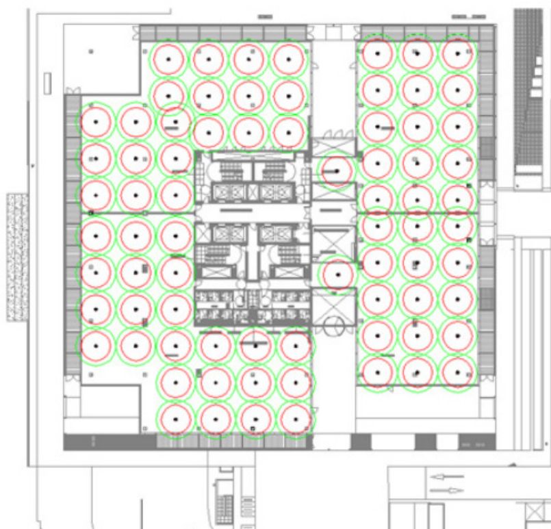
Figura 3 – Distribución de altavoces según el método prescriptivo de la norma UNE-EN 23007-32.
