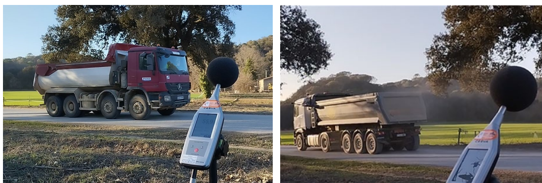
Figura 4.5 – Caracterización acústica del tráfico de camiones.
