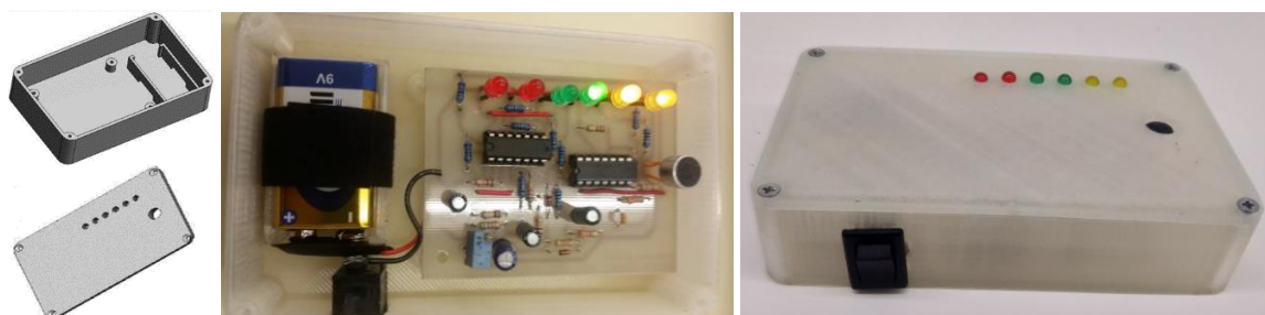
Figura 9 – “Sonómetro”: Caixa desenvolvida em 3D, e sistema já instalado.
