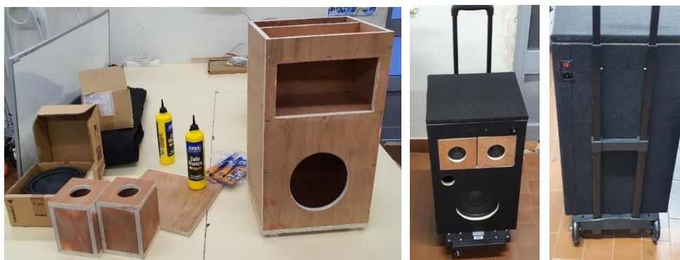
Figura 6 – Construção do sistema de reprodução portátil (à esquerda na fase inicial, à direita, quase concluída: vistas frontal e traseira, incluindo trolley de transporte).
