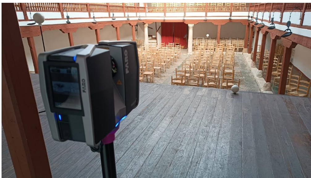
Figura 1 – Fotografía de un escaneo del corral con FARO Focus 3D.
