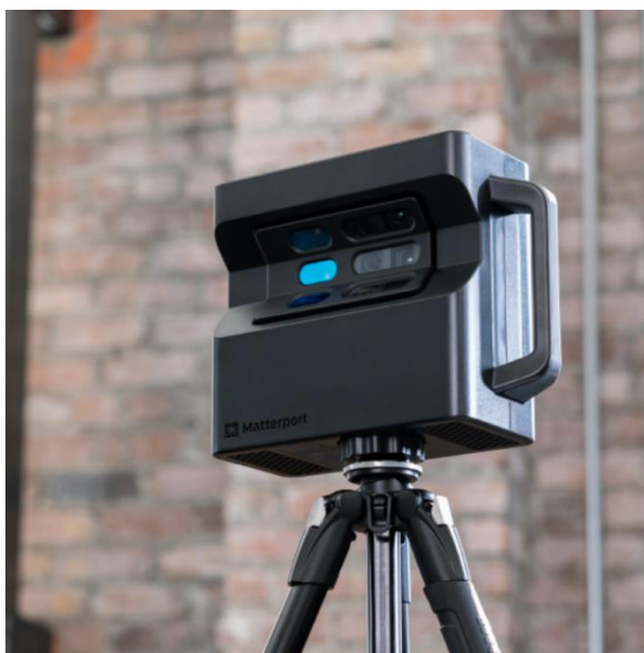
Figura 3 – Fotografía de un escaneo del corral con Matterport Pro 2.
