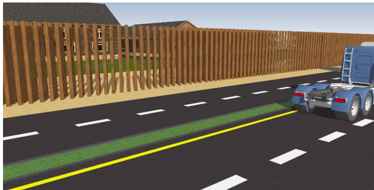
Imagem ilustrativa do conceito desenvolvido no projeto “SCLog”, com uma barreira acústica desenvolvida com troncos de madeira.
